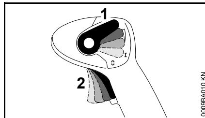
De gashendel (2) kan traploos worden gearrêteerd met behulp van de stelknop (1):
