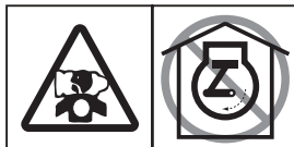
Motoren slipper ut giftig karbonmonoksyd. Ikke la motoren stå på i et lukket rom.
