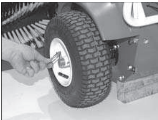
2) Eerst de machine met kanhout opbikken en daarna het wiel afnemen.
