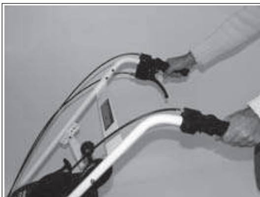
4) Door het bedienen van beide schakelhendels worden zowel veegborstel- alsook rijaandrijving ingeschakeld.
