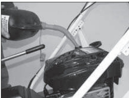
2) Houd de jerrycan zoals op de afbeelding. Vul slechts een kleine hoeveelheid en controleer de vulhoogte.
