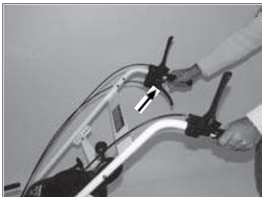
1) De onderste schakelhendel aan de rechtergreep schakelt de achteruitversnelling in.
