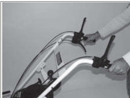
1) Aan de duwboom bevinden zich de bedieningshendels voor de rij- en veegborstelaandrijving.
