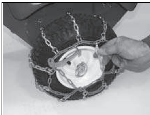
4) De ketting rond het leggen en vastzetten met de haak.
