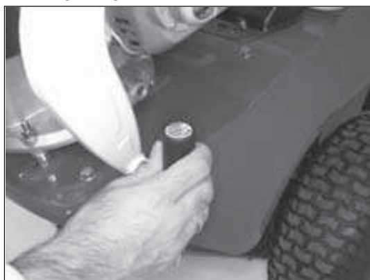
3) Versnellingskeuzehendel naar voren: 3e versnelling = snel
