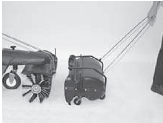
2) Voor het overbrengen van het veeggoed in een ander reservoir (b.v. kruiwagen), de opvangbak volledig afnemen.
