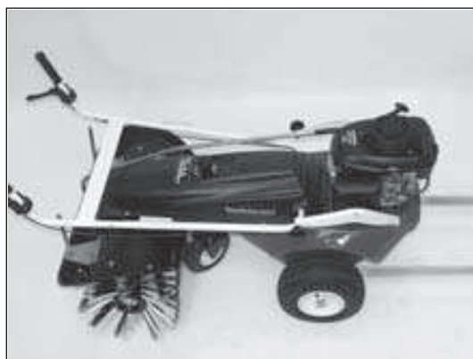
4) De duwboom wordt helemaal naar voren geklapt.
