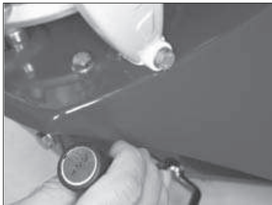
1) Versnellingskeuzehendel naar achteren: 1e versnelling = langzaam
