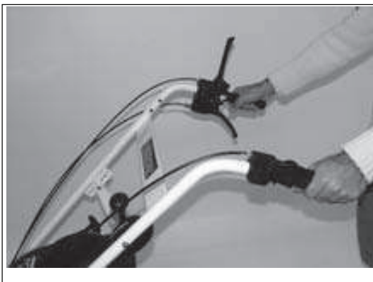
3) Met de linker hand wordt de veegborstel ingeschakeld.
