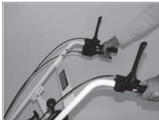
2) Zolang u de schakelhendel indrukt, loopt de machine achteruit.
