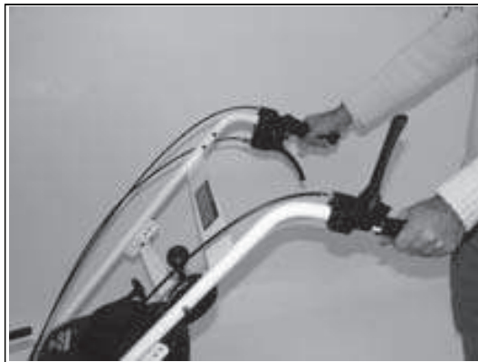
2) Door het indrukken van de bovenste hendel rechts schakelt u de rijaandrijving (vooruit) in.
