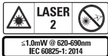
As ferramentas DWHT77100 emitem um feixe laser visível, como indicado na Figura A 1. O feixe laser emitido é um laser de classe 2 de acordo com a norma IEC 60825-1.
