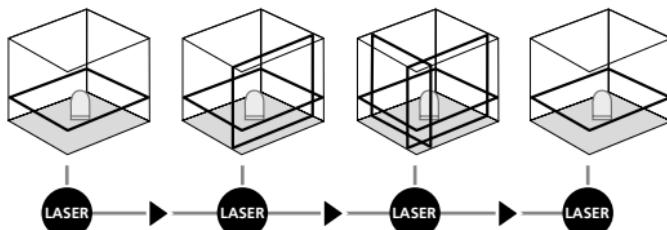
! Per il livellamento orizzontale e verticale si deve allentare la sicura di trasporto. Non appena l'apparecchio si viene a trovare al di fuori del campo di livellamento automatico di  $3,5^\circ$ , le linee laser iniziano a lampeggiare e viene emesso un segnale acustico. Posizionare l'apparecchio in modo che si trovi all'interno del campo di livellamento.
