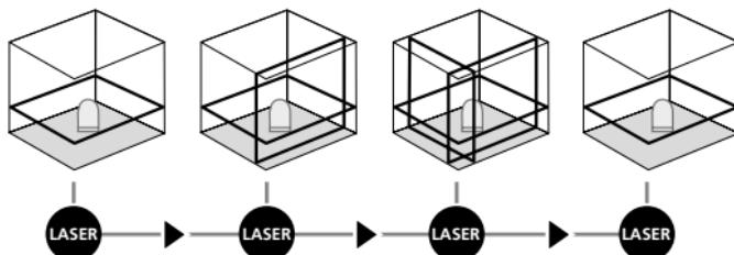
! Zum horizontalen und vertikalen Nivellieren muss die Transportsicherung gelöst sein. Sobald sich das Gerät außerhalb des automatischen Nivellierbereichs von  $3,5^\circ$  befindet, blinken die Laserlinien. Positionieren Sie das Gerät so, das es sich innerhalb des Nivellierbereichs befindet.
