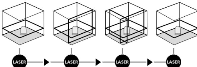
! Para poder efectuar la nivelación horizontal y vertical tiene que estar suelto el seguro de transporte. Cuando el aparato se encuentra fuera del rango automático de nivelación de 3,5° las líneas láser parpadean y suena una señal acústica. Coloque el aparato en una posición dentro del rango de nivelación.
