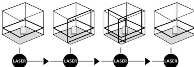
! Do niwelacji poziomej i pionowej zabezpieczenie transportowe musi być zwolnione. Gdy urządzenie znajduje się poza automatycznym zakresem niwelacji wynoszącym  $3,5^\circ$ , linie laserowe migają i rozlega się sygnał dźwiękowy. Ustawić urządzenie tak, aby znalazło się w zakresie niwelacji.
