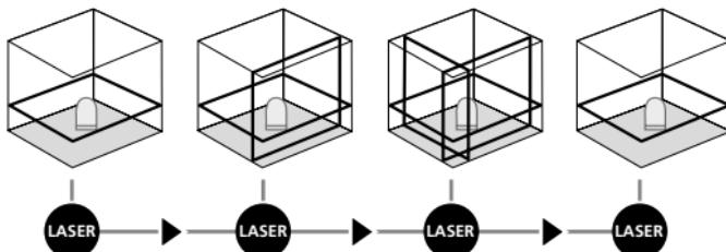
! Voor de horizontale en verticale nivelleren moet de transportbeveiliging gedeactiveerd zijn. Zodra het apparaat zich buiten het automatische nivelleerbereik van 3,5° bevindt, knipperen de laserlijnen en klinkt een signaal. Positioneer het apparaat zodanig dat het zich binnen het nivelleerbereik bevindt.
