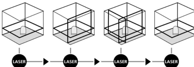
! Il est nécessaire de dégager le blocage de transport pour procéder au nivellement horizontal et vertical. Dès que l'instrument se trouve en dehors de la plage de nivellement automatique de 3,5°, les lignes laser clignotent et un signal retentit. Positionner l'instrument de manière à ce qu'il soit dans la plage de nivellation.
