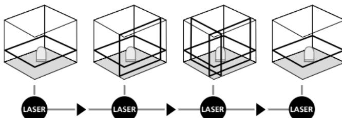
! Til horisontal og vertikal nivellering skal transportsikringen være løsnet. Så snart apparatet er uden for det automatiske nivelleringssområde på  $3,5^\circ$ , blinker laserlinjerne og der lyder et signal. Apparatet skal positioneres således, at det er inden for nivelleringssområdet.
