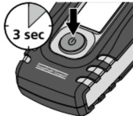
Nach dem Einschalten des Gerätes wird im Display für 3 Sekunden die Umgebungstemperatur angezeigt.
