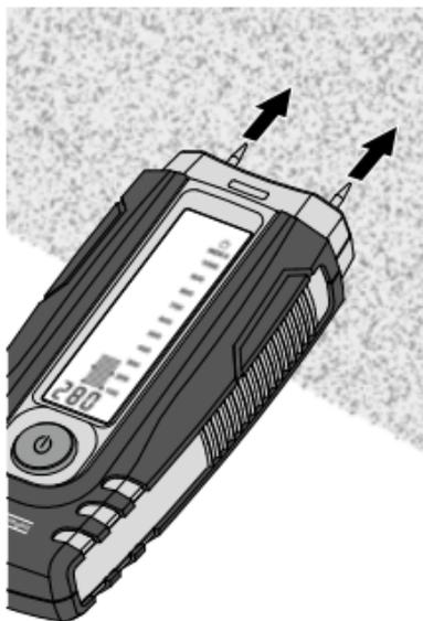
Tenere presente che nelle pareti (superfici) con diversa disposizione del materiale o anche con diversa composizione del materiale i risultati di misura possono essere falsificati.
