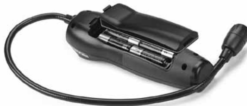
Figura 4 – Remoção da tampa do compartimento das pilhas
