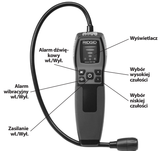
Rysunek 2 – Części micro CD-100
