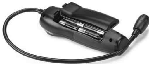
Εικόνα 4 - Αφαίρεση του καλύμματος των μπαταριών
