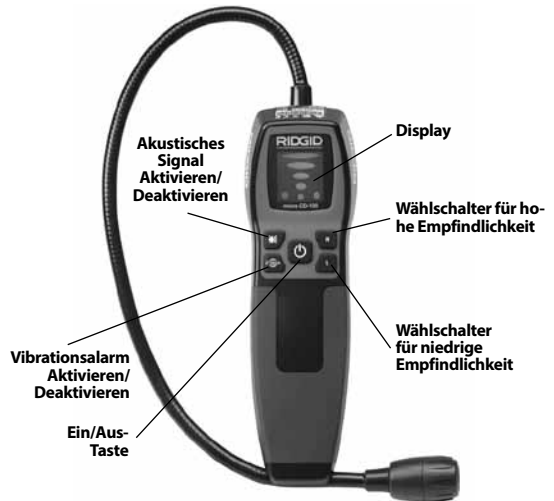
Abbildung 2 – Teile des micro CD-100
